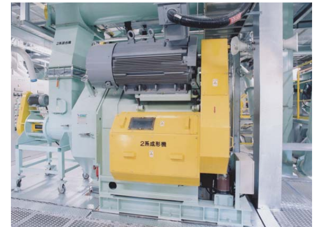
成形機 ごみを圧縮してペレット状の固形物に成形します。
