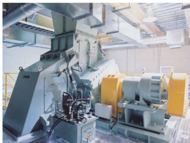
破袋機 ホッパに投入されたごみ袋を破り、ごみを粗破砕します。
