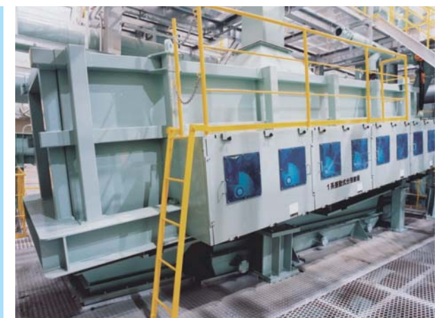
揺動式分別装置 破砕ごみを軽量物、重量物、及び小径粒物に分別します。
